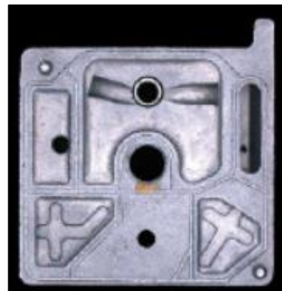
Obr. 25 Kovový objekt po osvětlení kopulovým osvětlovačem [13]
