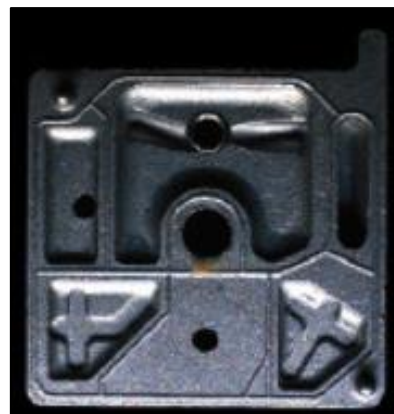
Obr. 15 Kovový objekt po osvětlení plošným osvětlovacím polem [13]
