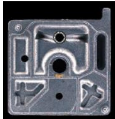
Obr. 21 Kovový objekt po osvětlení kruhového osvětlovače [13]
