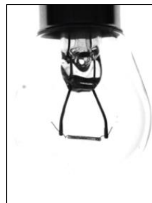
Obr. 37 Kovový objekt po osvětlení backlight osvětlovačem [13]
