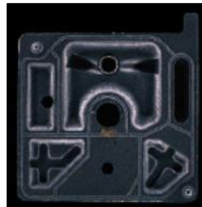
Obr. 33 Kovový objekt po osvětlení dark-field osvětlovačem [13]
