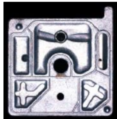
Obr. 29 Kovový objekt po osvětlení coaxiálním osvětlovačem [13]
