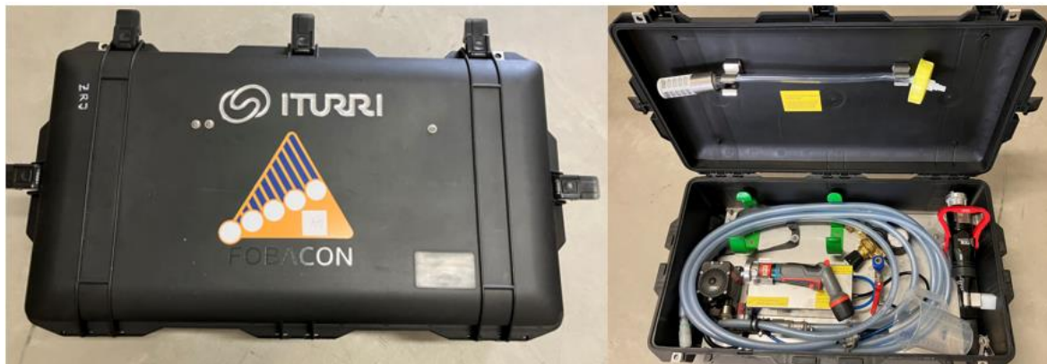
Obrázek 14: Dekontaminační souprava Quick Fobacon (Zdroj: Vlastní, 2024)
