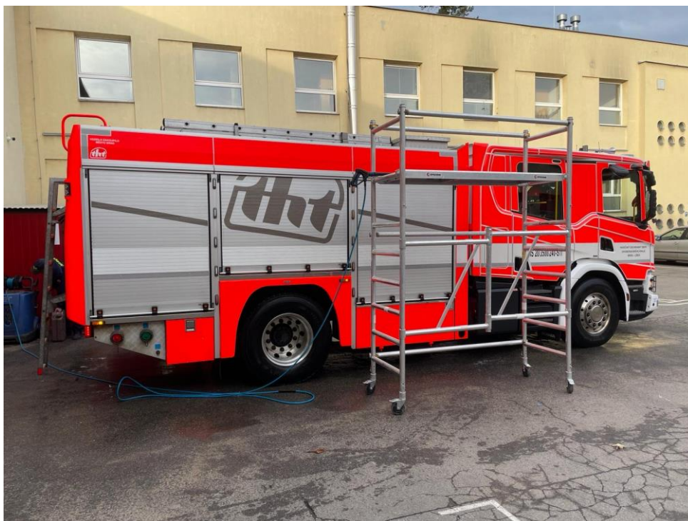
Obrázek 20: Využití lešení pro dekontaminaci vozidel (Zdroj: Vlastní, 2024)
