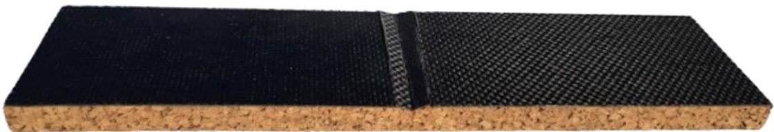
Obrázek 72 Poruchy sendvičové struktury s korkovým jádrem u zkoušky cyklickým ohybem
