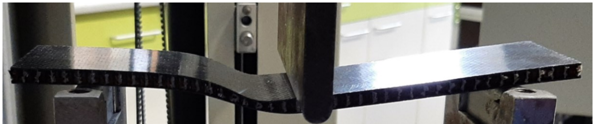
Obrázek 51 Poruchy sendvičů s voštinovým jádrem
