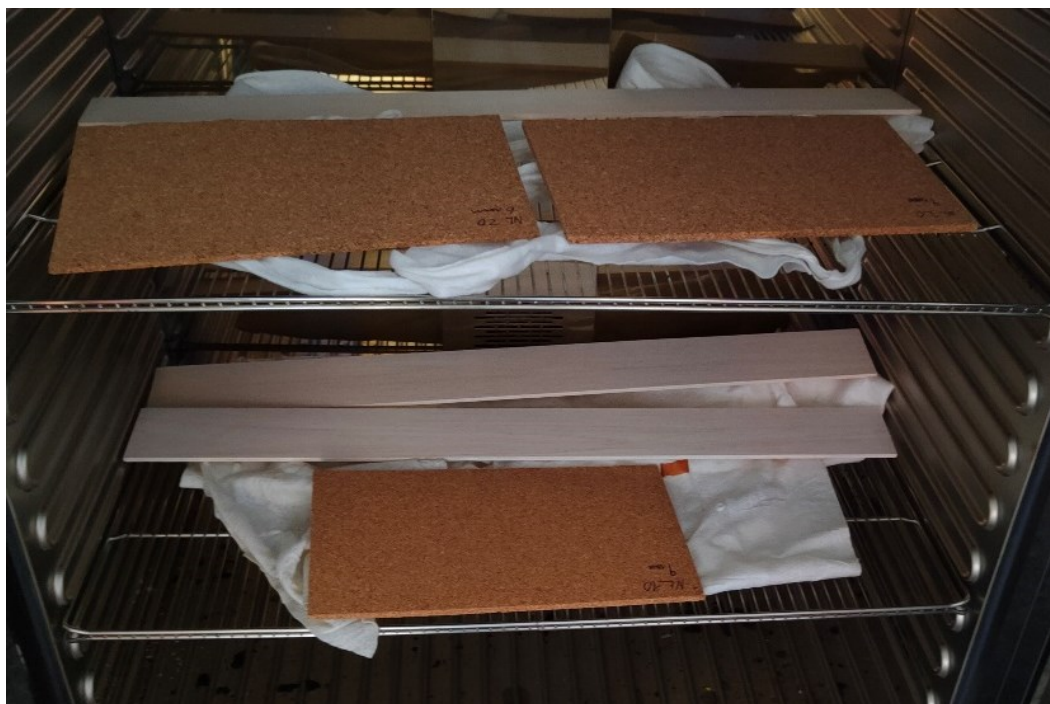
Obrázek 39 Balsa a korek v sušárně
