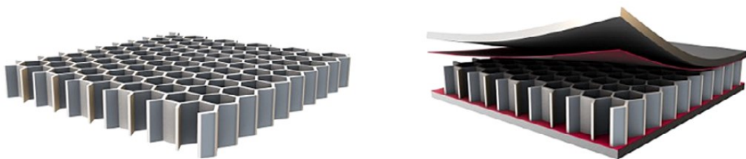
Obrázek 10 Voština a její struktura v sendviči [16]
