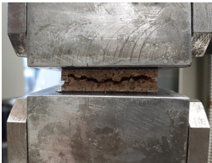
Obrázek 85 Poruchy sendvičů s pěnovým jádrem
