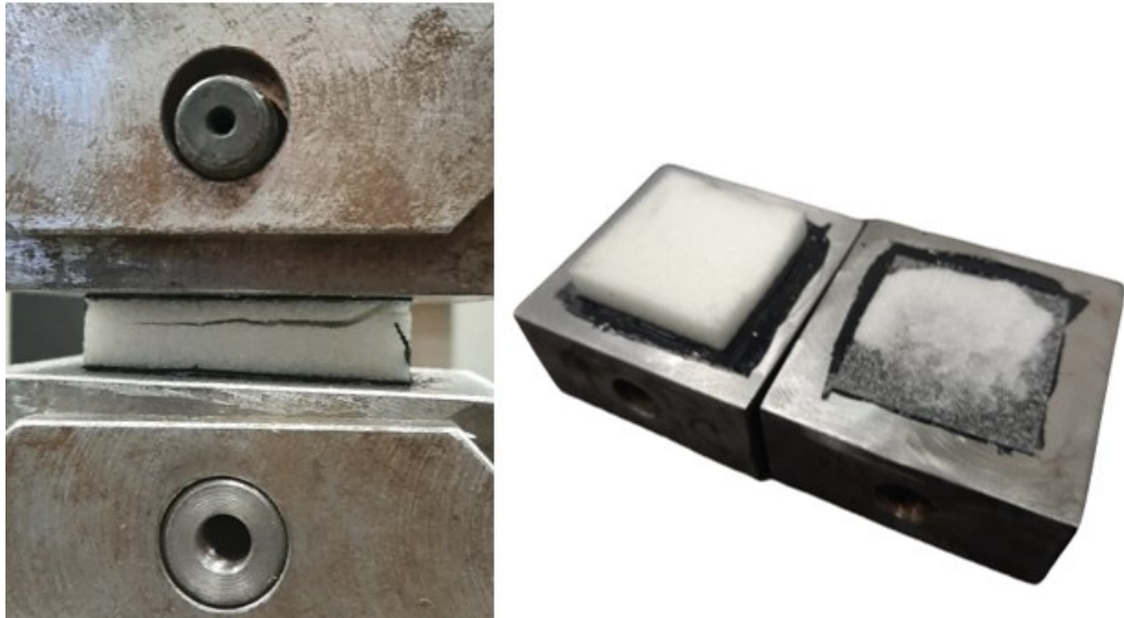
Obrázek 79 Poruchy sendvičů s pěnovým jádrem
