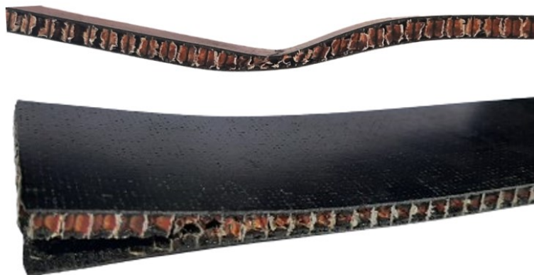
Obrázek 68 Poruchy sendvičové struktury s voštinovým jádrem u zkoušky cyklickým ohybem
