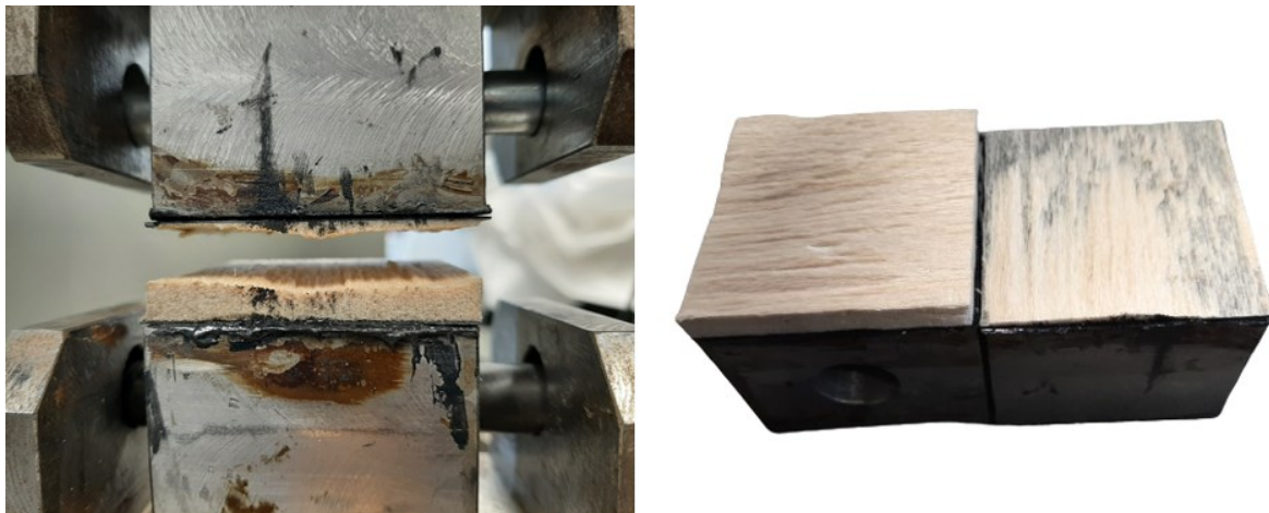
Obrázek 88 Poruchy sendvičů s balsovým jádrem
