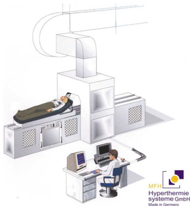
Obrázek 5: Náčrt prototypu aplikátoru střídavého magnetického pole pro magnetickou hypertermii (MFH Hyperthermie systeme GmbH, Berlín, Německo) [22]
