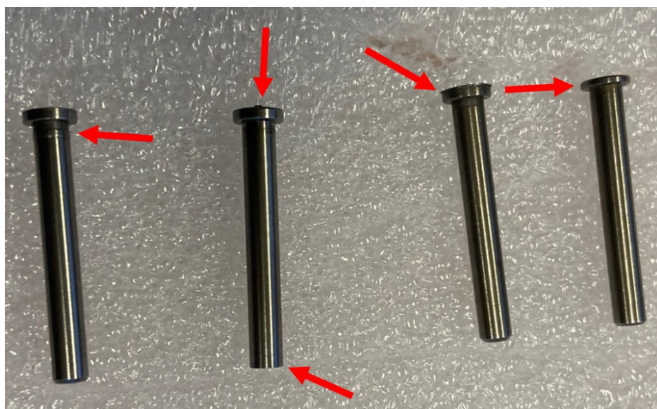
Obrázek 21 Kolíky s čepičkou mimo specifikaci, Zpracování: Vlastní
