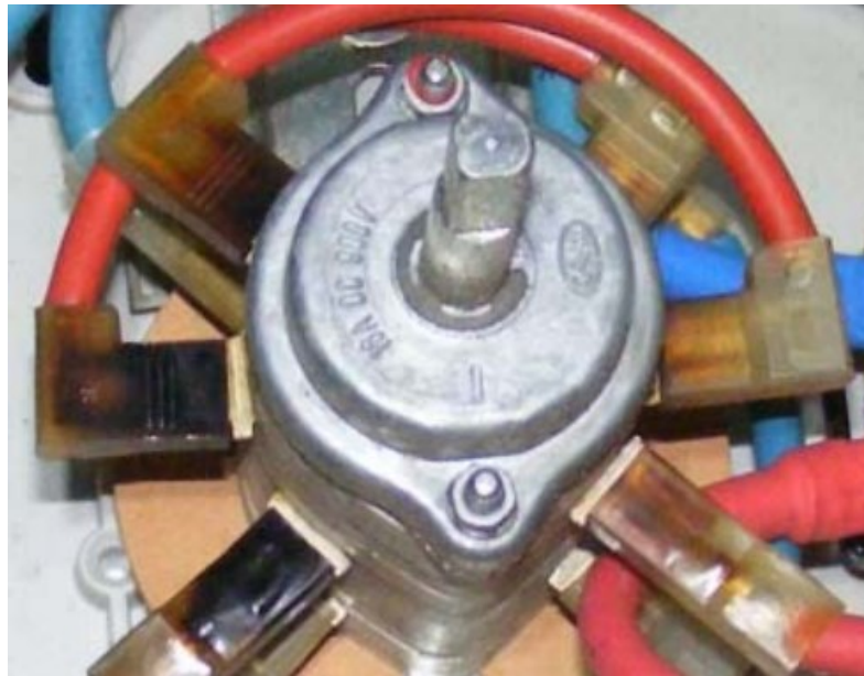
Obrázok 19 – DC izolátor so zuhoľnatenými svorkami po šiestich rokoch prevádzky [44]
