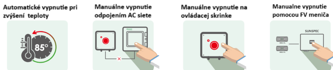
Obrázok 23 – možnosti vypnutia zariadenia RSD [vlastný]
