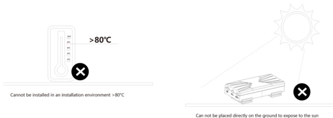
Obrázok 24 – podmienky montáže zariadenia PROJOY PEFS- PL120S-21 [50]
