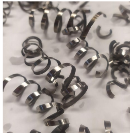
Obrázek 47 Zbarvení a tvar třísky- 60 bar
