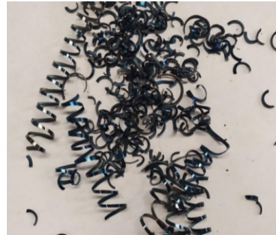
Obrázek 28 Zbarvení a tvar třísky – bez chlazení
