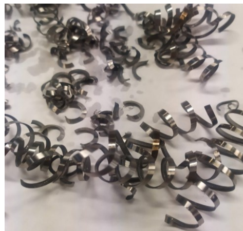
Obrázek 43 Zbarvení a tvar třísky- 50 bar
