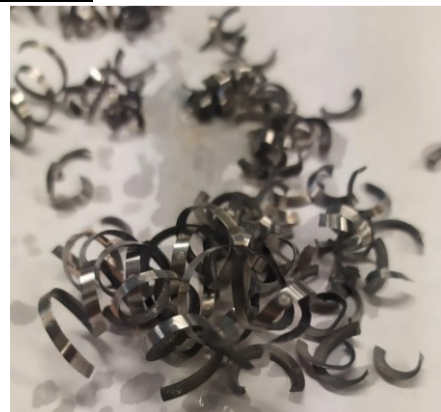
Obrázek 49 Zbarvení a tvar třísky- 70 bar
