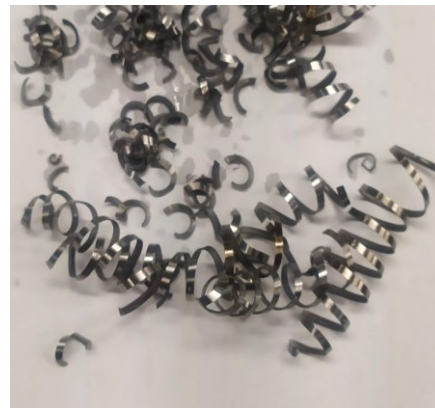
Obrázek 38 Zbarvení a tvar třísky- 30 bar
