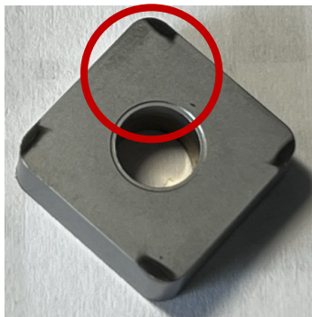
Obrázek 45 Opotřebení břitové destičky- 50 bar
