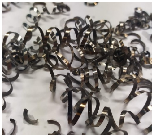
Obrázek 32 Zbarvení a tvar třísky- 10 bar
