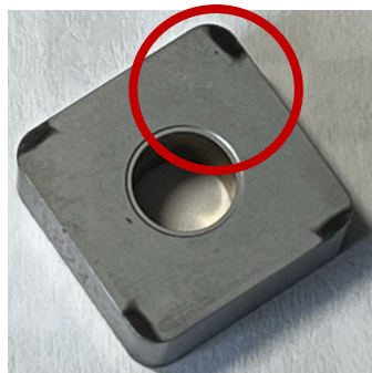
Obrázek 39 Opotřebení břitové destičky- 30 bar
