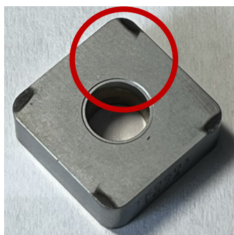
Obrázek 42 Opotřebení břitové destičky- 40 bar
