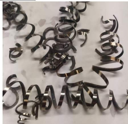
Obrázek 35 Zbarvení a tvar třísky- 20 bar
