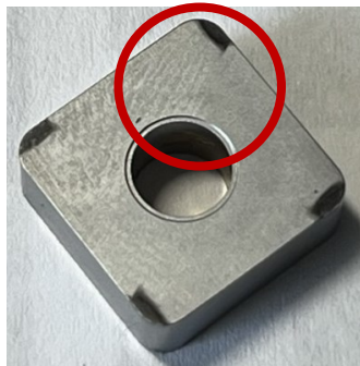
Obrázek 46 Opatření břitové destičky- 60 bar
