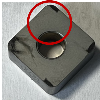
Obrázek 36 Opotřebení břitové destičky- 20 bar
