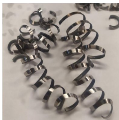
Obrázek 41 Zbarvení a tvar třísky- 40 bar
