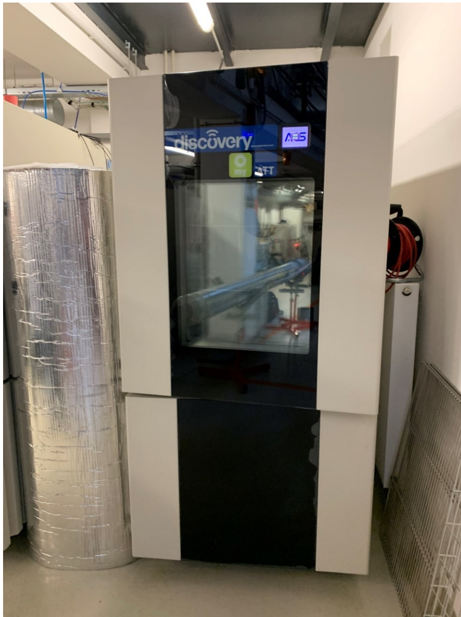
Obrázek 47 - Využitá teplotní komora na -40\text{ }^{\circ}\text{C}
