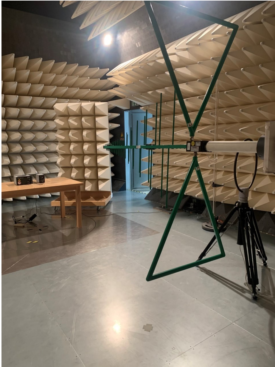
Obrázek 33 - Prostředí semi-anechoické komory využité k měření společně s anténou CBL 6112D
