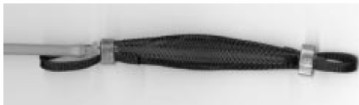
Obr. 5: Pneumatický sval s nylonovým opletením
