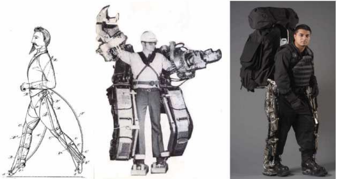
Obr. 22: Yagnův model na podporu chůze[42], General Electric je Hardiman [43], a University of California v Berkeley je exoskeleton BLEEX[44].
