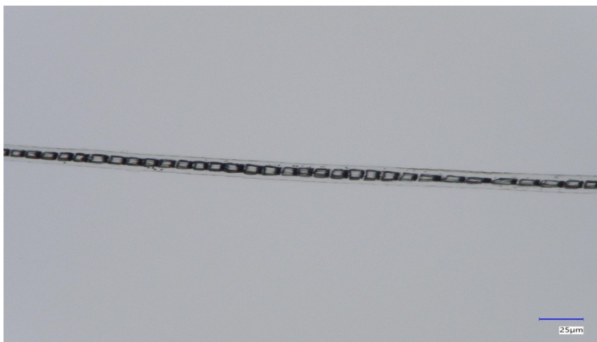
Obr. 47: Struktura meduly králíčiho chlupu (vzorek č. 7, břicho) [zdroj: vlastní]
