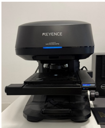
obr. 15: Laserový mikroskop Keyence VK-X1000 [zdroj: vlastní]
