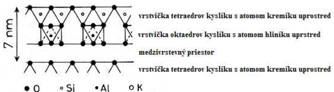
Obr. 9. Striedanie tetraedických a oktaedrických vrstiev [10].
