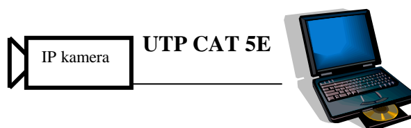
Obr. 32 Přímé spojení IP kamery s počítačem
