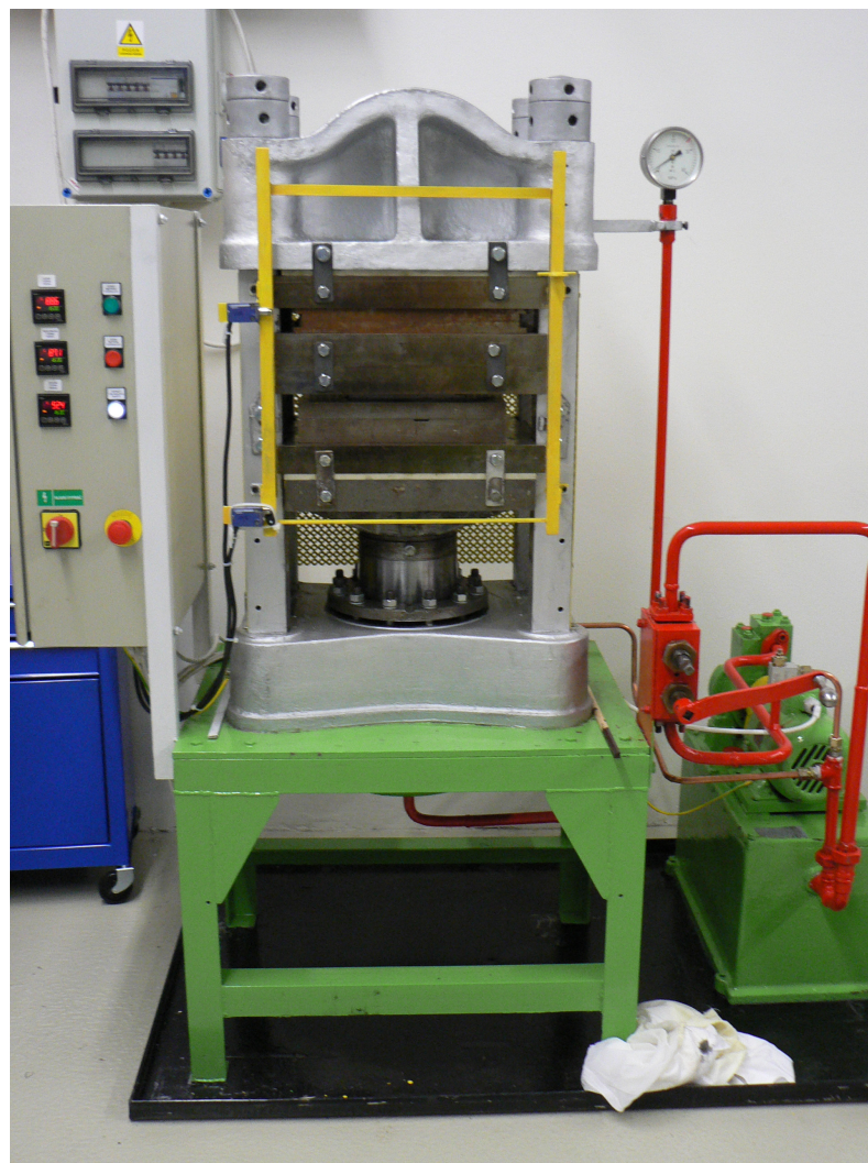
Obr. 6. Vulkanizační etážový lis 400x400 s hydraulickým pohonem
