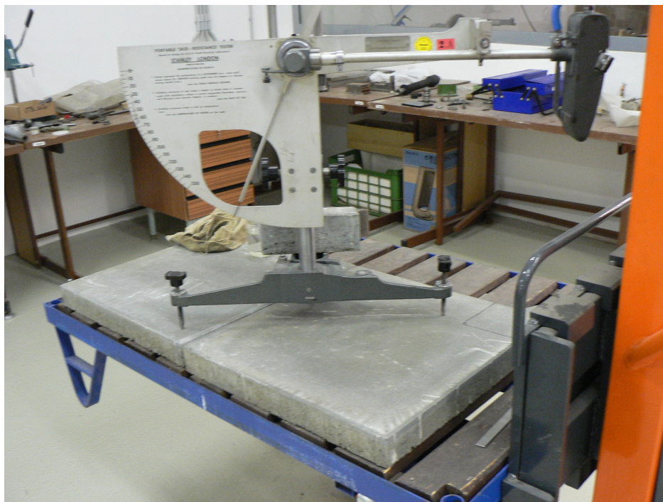
Obr. 14. Skid tester na suchem betonovém povrchu
