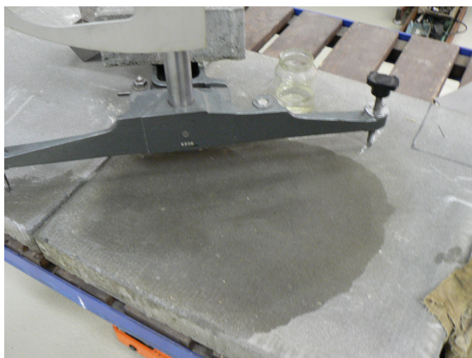
Obr. 15. Zvlhčený povrch betonu
