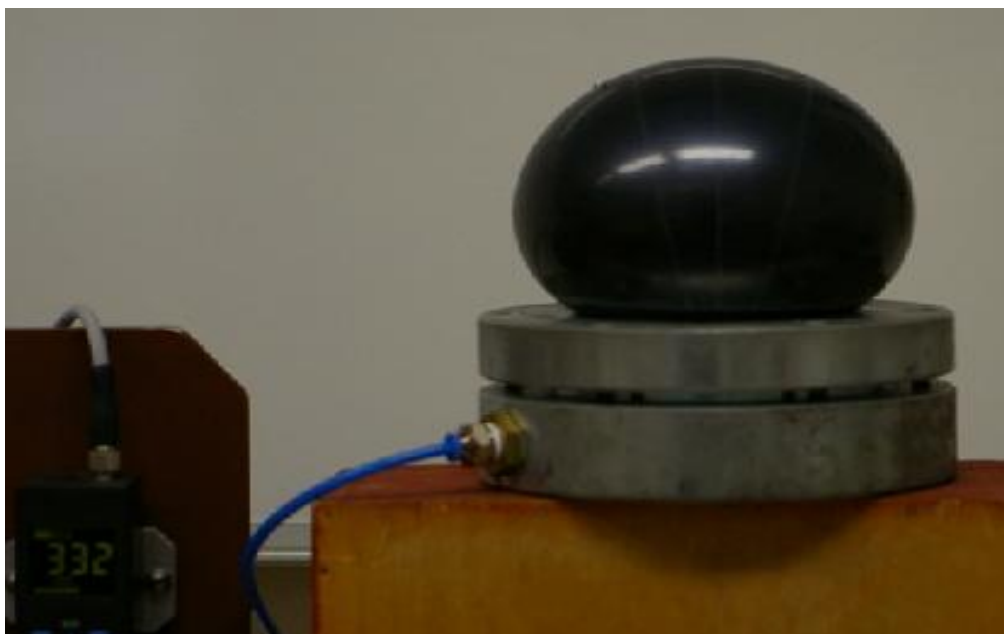
Obr. 23. Konec zkoušky nafukováním (hodnota tlaku na obrázku je v kPa)
