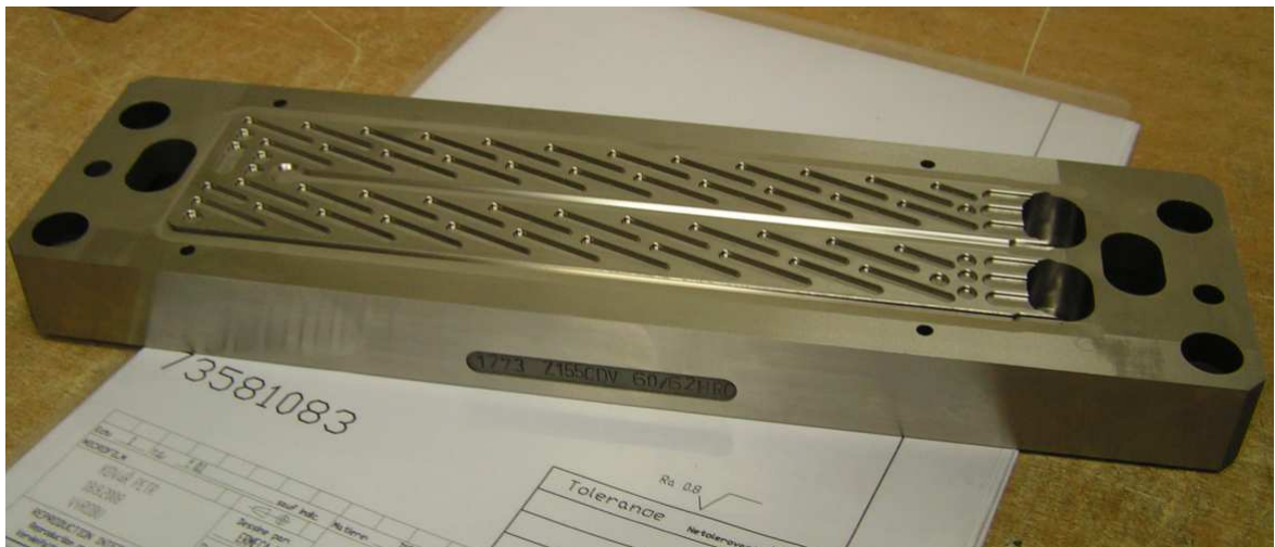
Obr. 9. Plocha obrobku vyrobena pomocí CAD/CAM systému (přes 45 tisíc řádků)
