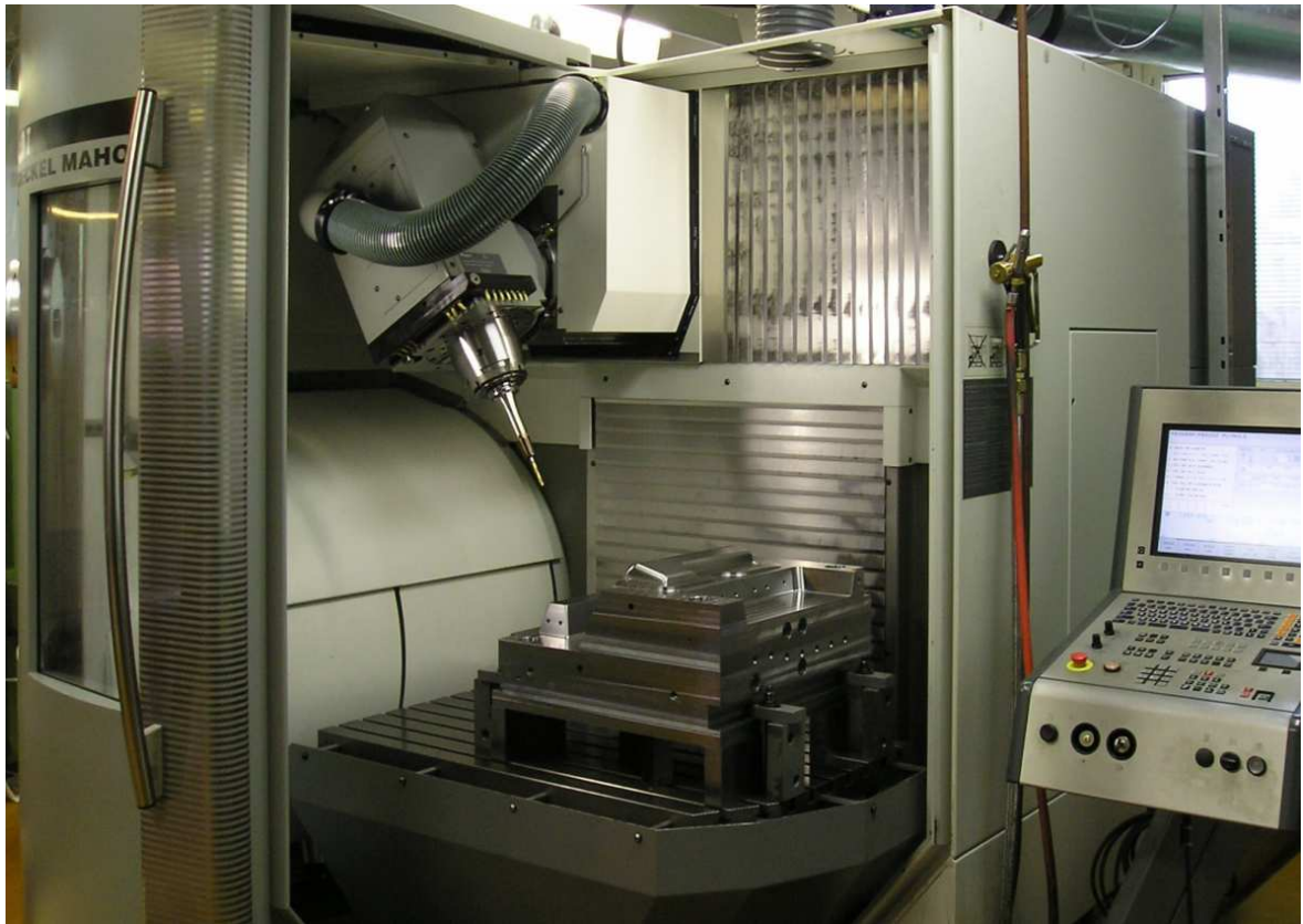
Obr. 1. CNC stroj s vykloněným vřetenem
