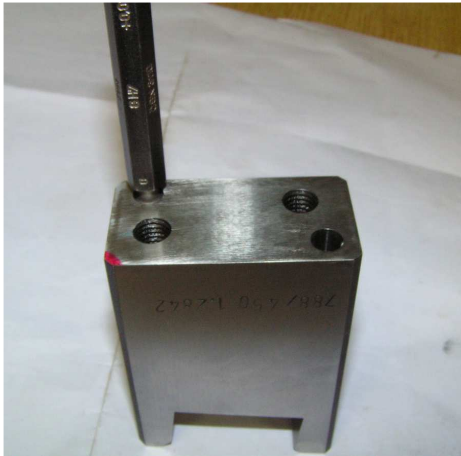
Obr. 36 . Měření průměru díry pomocí kalibru
