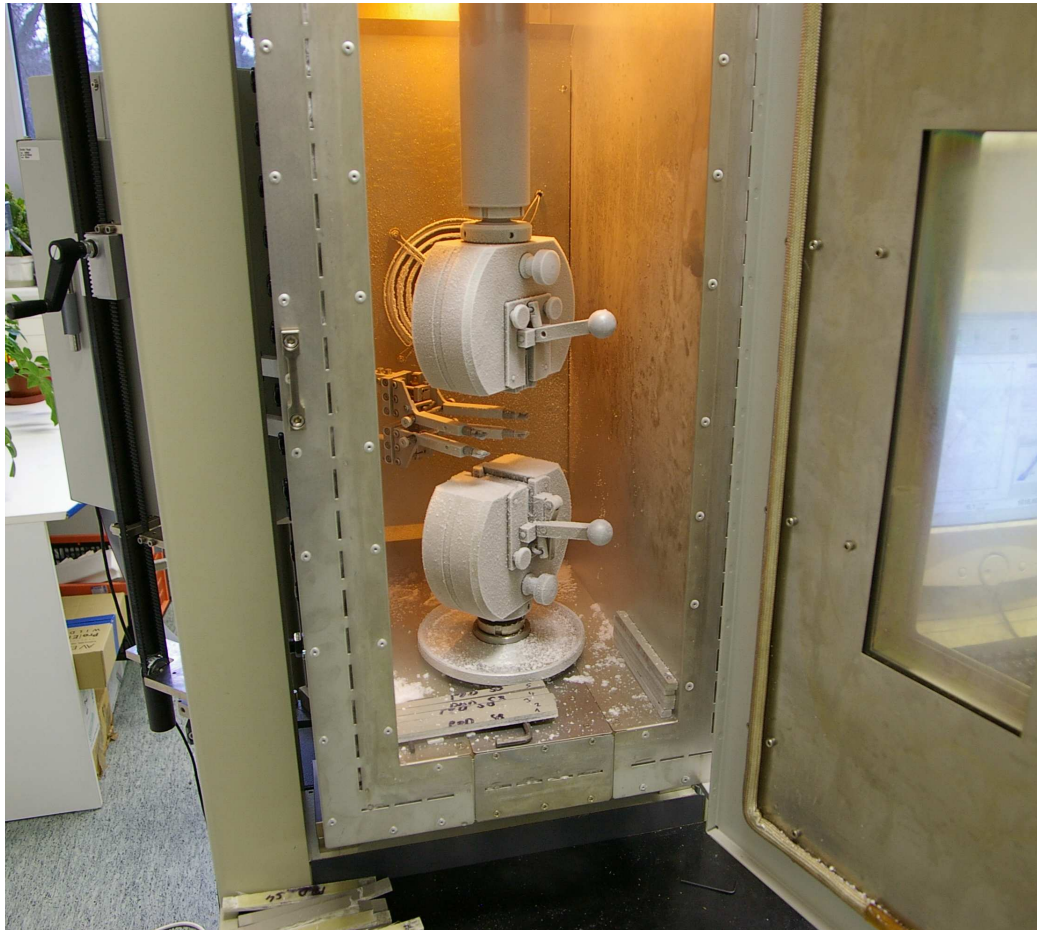
Obr. 41. Zkouška tahem v teplotní komoře při teplotě -30^{\circ}\text{C}
