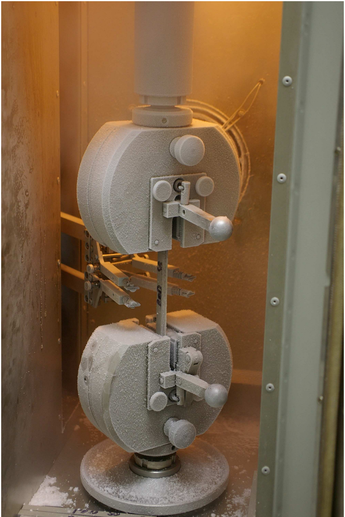
Obr. 40. Zkouška tahem v teplotní komoře
