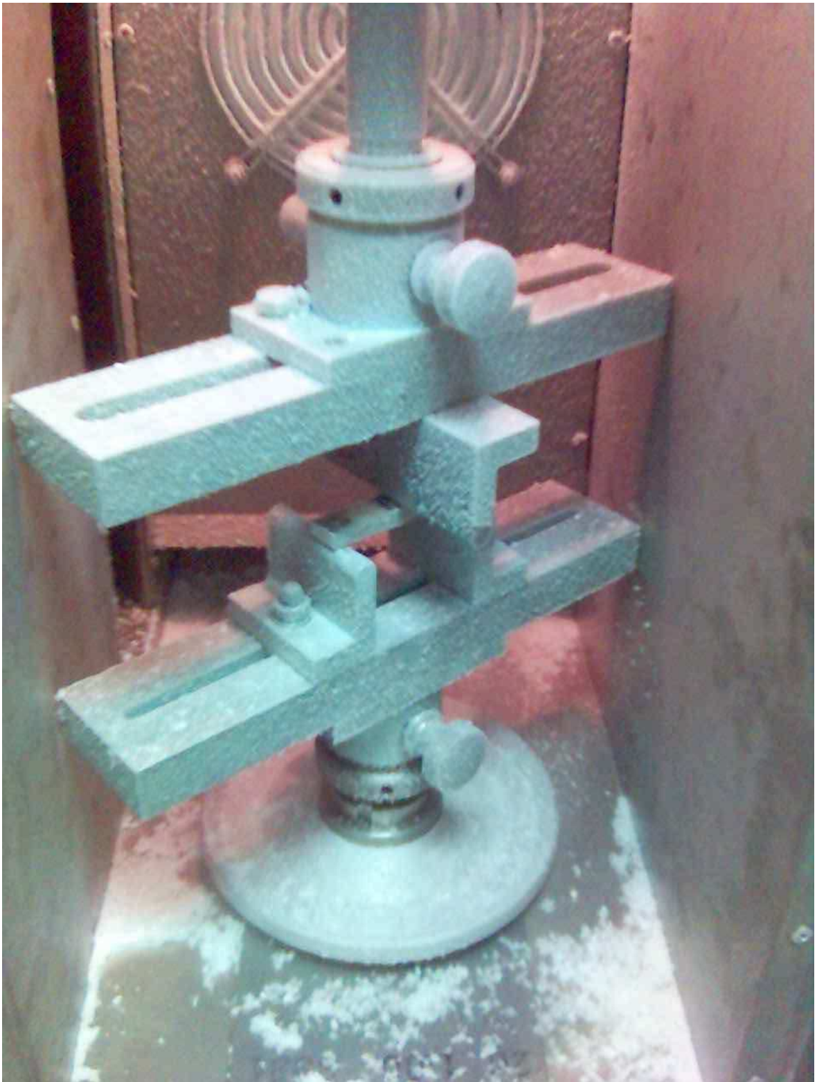
Obr. 58. Zkouška ohybem v teplotní komoře
