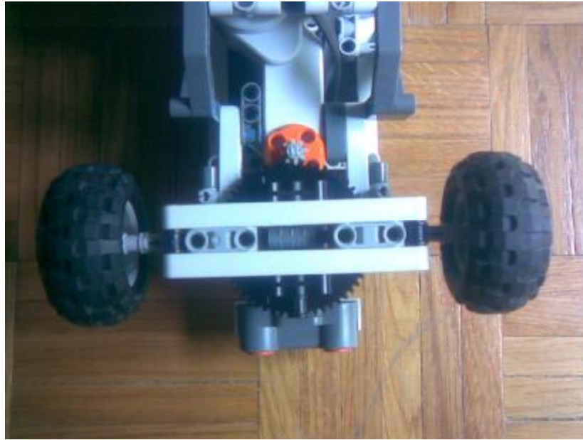
Obr. 16 - Řídící systém finální řešení převod 8 : 54
