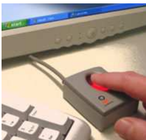
Obr. 40: Zařízení U.are.U Personal od společnosti DigitalPersona
