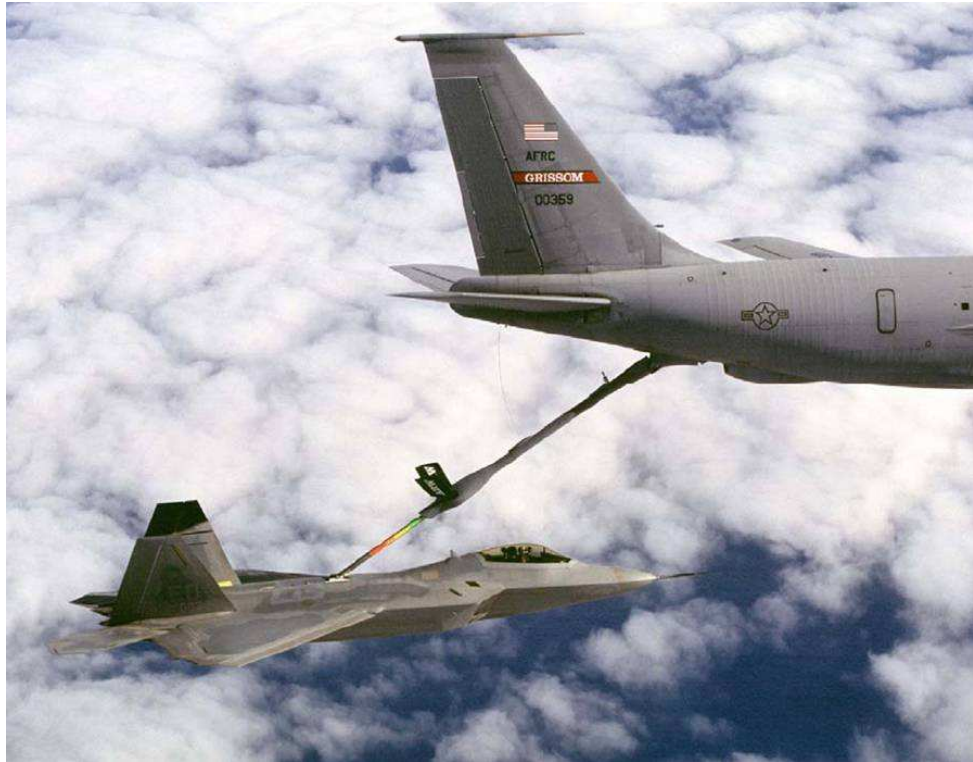
Obr. 20. Speciální hlavice pro doplňování paliva.
