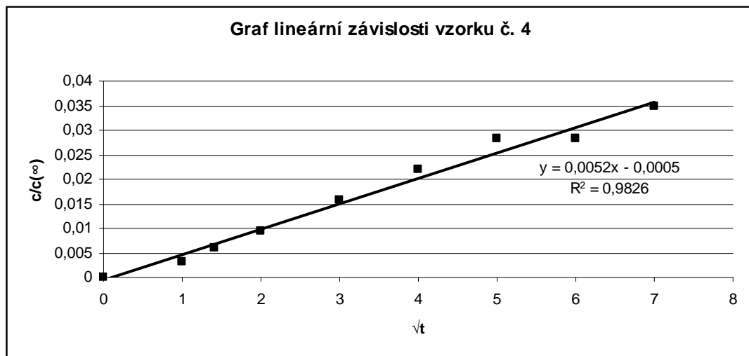
Obrázek 26: Závislost c/c_{\infty} na \sqrt{t} pro počáteční fázi měření
