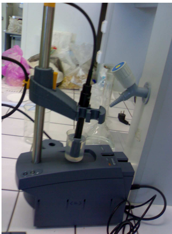
Obrázek 19: Měřicí modul inoLab 740
