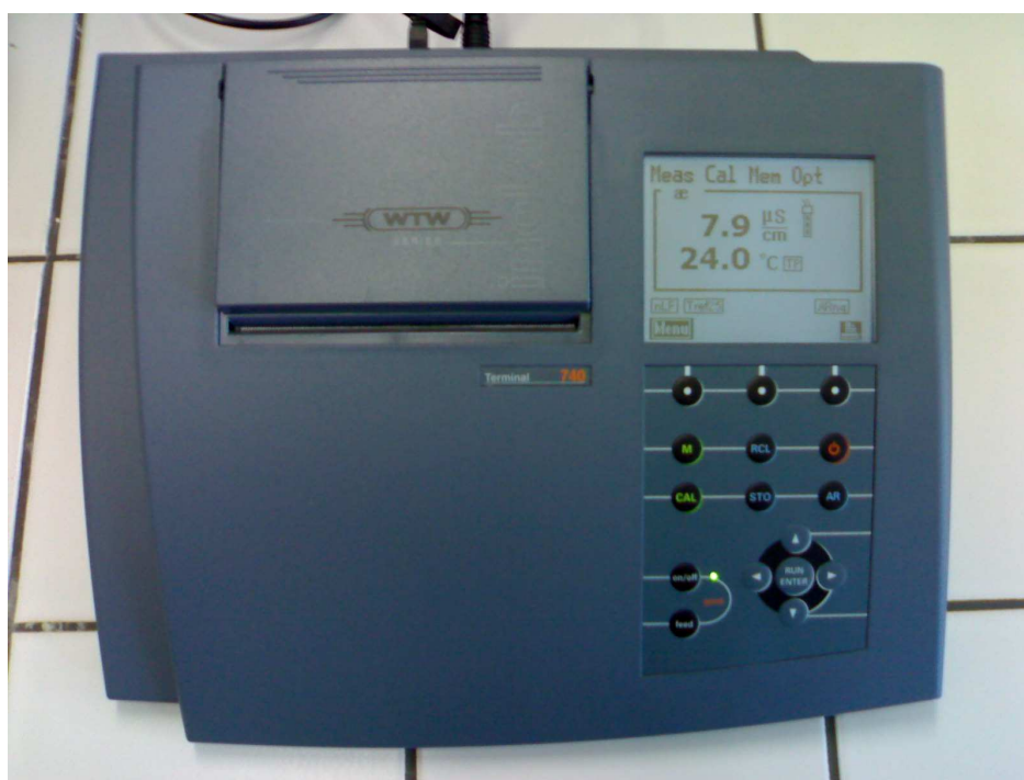
Obrázek 18: Měřicí přístroj InoLab 740
