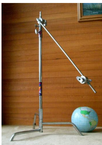
Obrázek 8 Ukázka c-standu s přichyceným gobo arm (zdroj: www.wikipedia.org 11 )
