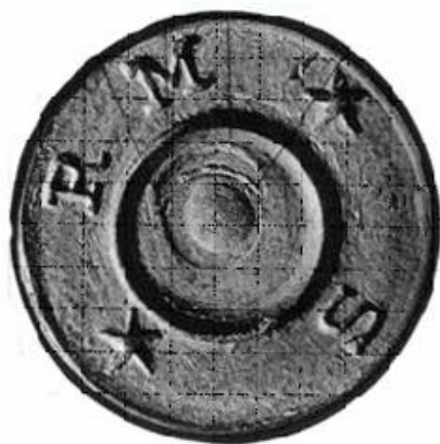
Obr. 3. Statická plastická stopa – vtisk (dno nábojnice)
