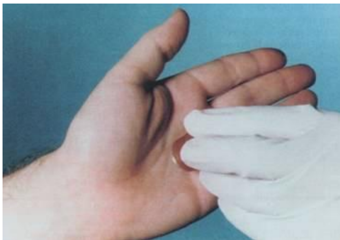
Obr. 13. Metoda olepení uhlíkovými terčičky
