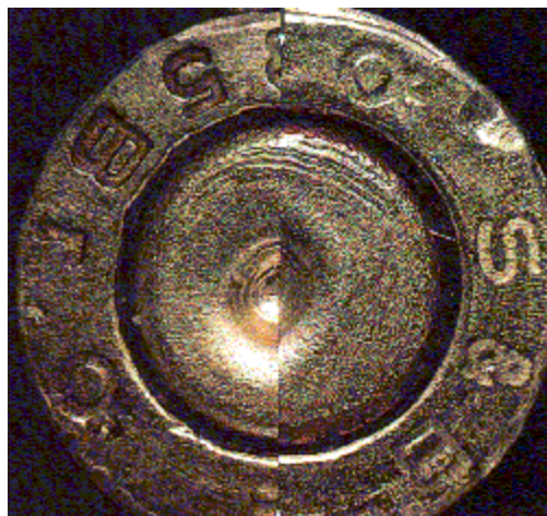
Obr. 7. Komparace stop dna nábojnice
