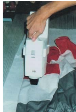
Obr. 16. Metody odběru vzorků filtračním zařízením
