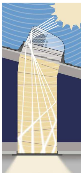
Obrázek 13: Šíření světla světlovodem (Zdroj: www.svetlovody.com [17])
