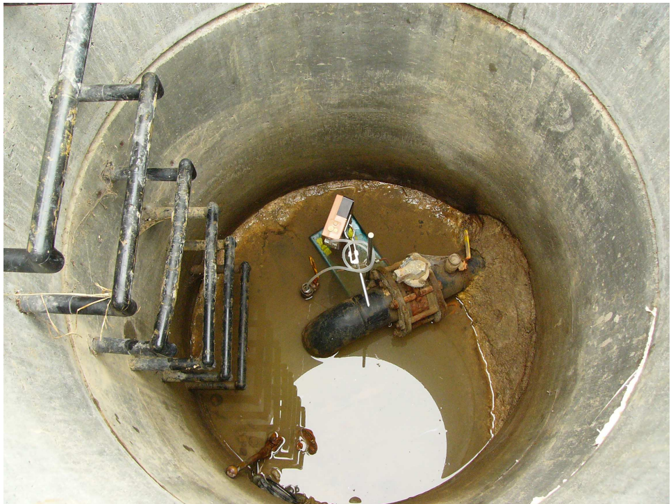
Obr. 9. Fotografie odběru směšného vzorku č.1 z II etapy skládky Suchý důl ve studni před plynosběrnou stanicí
