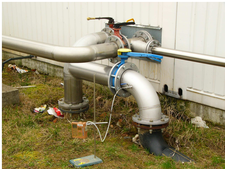
Obr. 10. Fotografie odběru směšného vzorku č.2 z II etapy skládky Suchý důl u plynoměrné stanice
