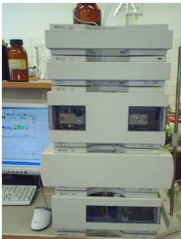
Obr. 10: Chromatografická sestava, na které byla provedena analýza vzorků sýrů
