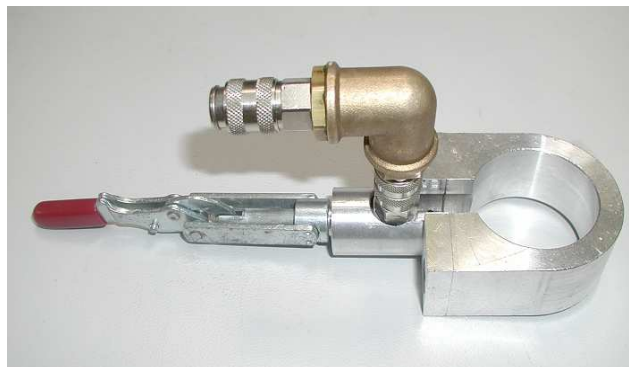
Obr. 55. Přípravek - pevnost spoje
