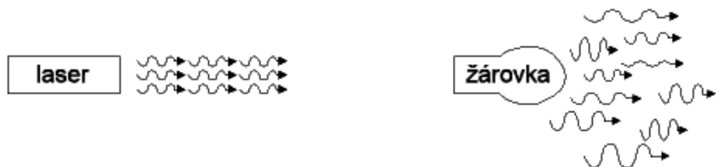
Obr. 1. Srovnání světla vyzařovaného laserem se světlem žárovky [23]
