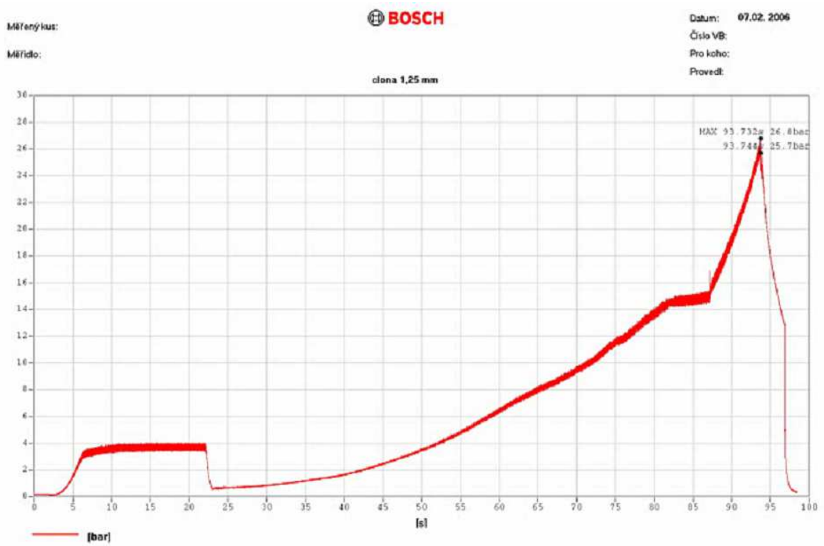
Obr. 39. Záznam statické zkoušky až do destrukce včetně plnicí fáze [18]
