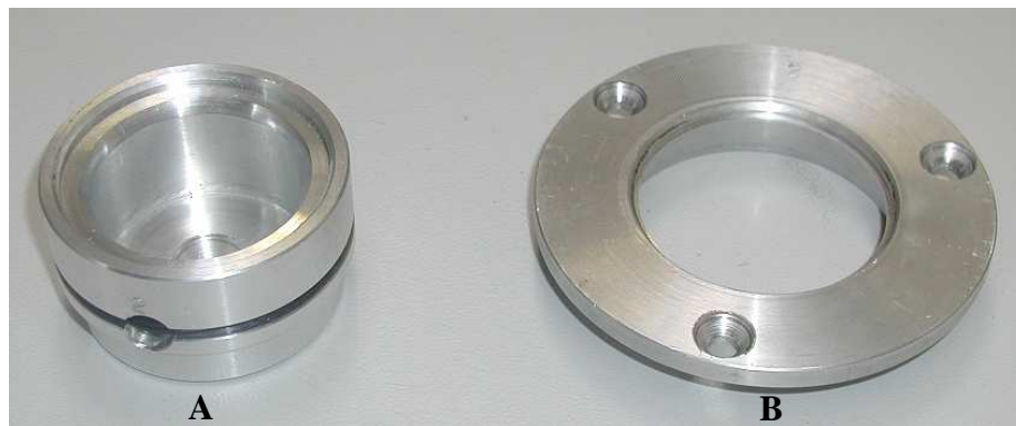
Obr. 52. Spodní (A) a horní (B) část svařovacího přípravku
