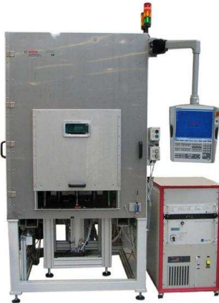
Obr. 31. Svařovací stanice LDS
