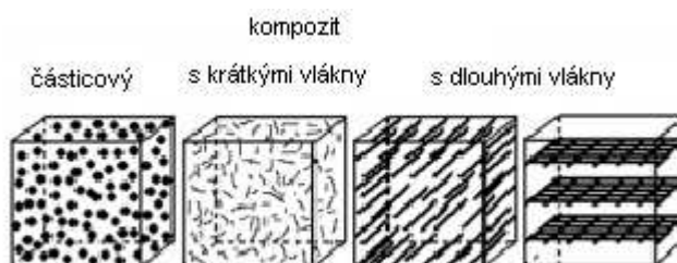
Obr. 4. Rozložení kompozitních materiálů podle geometrického tvaru výztuže
