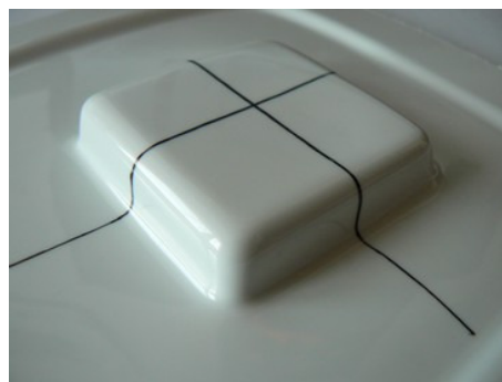
Obr. 39. Vytvarování modelu C při času 130 s pro tloušťku desky 2 mm
