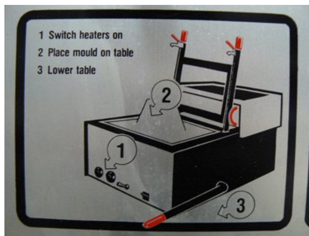
Obr. 28. Umístění modelu na tvarovací desku
