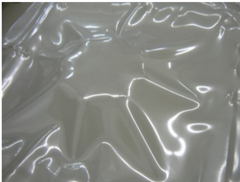
Obr. 33. Špatná tvarovatelnost zkušebního materiálu
