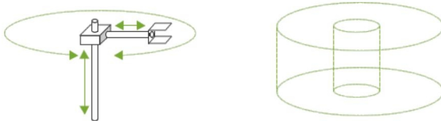
Obr. 7. Náčrt rozsahů pohybů a pracovního prostoru cylindrického robota
