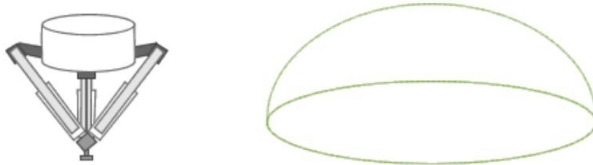
Obr. 15. Náčrt rozsahu pohybů a pracovního prostoru paralelních robotů
