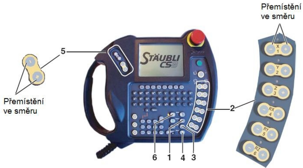
Obr. 25. Rychlý způsob ovládní pohybu ramene módem Frame(Rám) a Tool(Nástroj)
