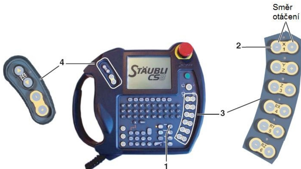
Obr. 23. Rychlý způsob ovládání pohybu ramene pro mód Joint(Kloub)
