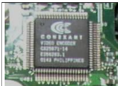
Obr. 15. Verzia 1.2 a 1.3 majú "Conexant" chip.
