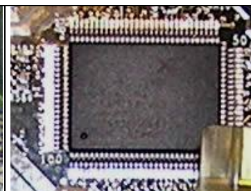
Obr. 17. Verzia 1.6 má "Excalibur" chip.
