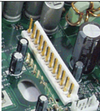
Obr. 12. Konektor napájania vo vrzií 1.0 a 1.1.
