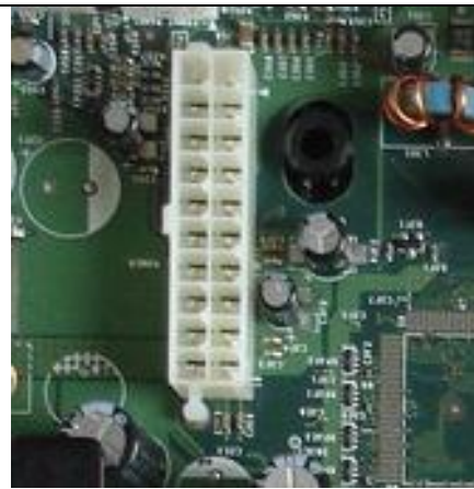
Obr. 13. Konektor napájania vo vrzií 1.2 až 1.6.
