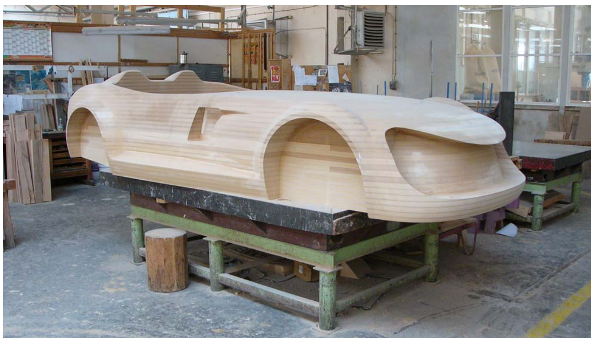
Obr. 73. Foto dřevěného modelu karoserie v měřítku 1:1
