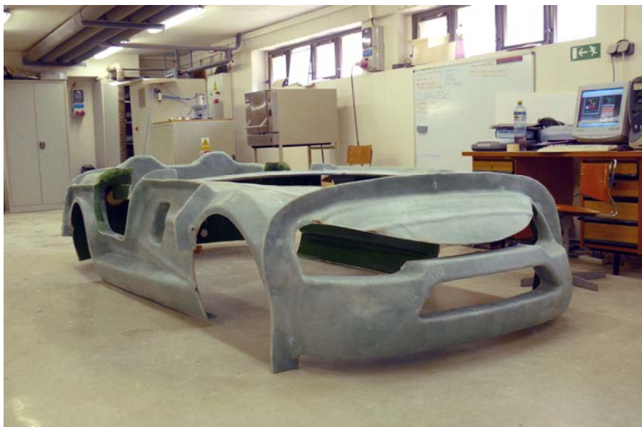
Obr. 75. Foto negativních forem sestavených do jednoho celku
