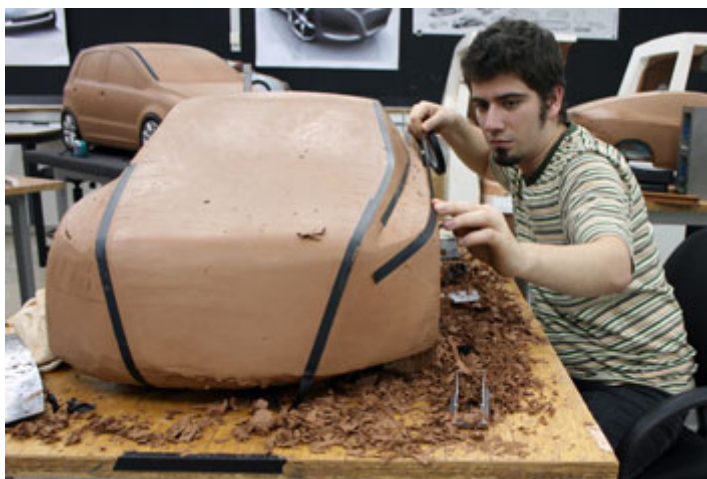
Obr. 52. Výroba modelu z hmoty clay
