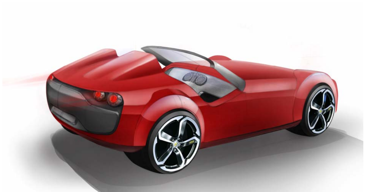
Obr. 64. Návrh finálního koncepčního řešení zadní partie
