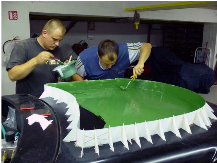
Obr. 74. Foto výroby jedné z negativních forem karoserie
