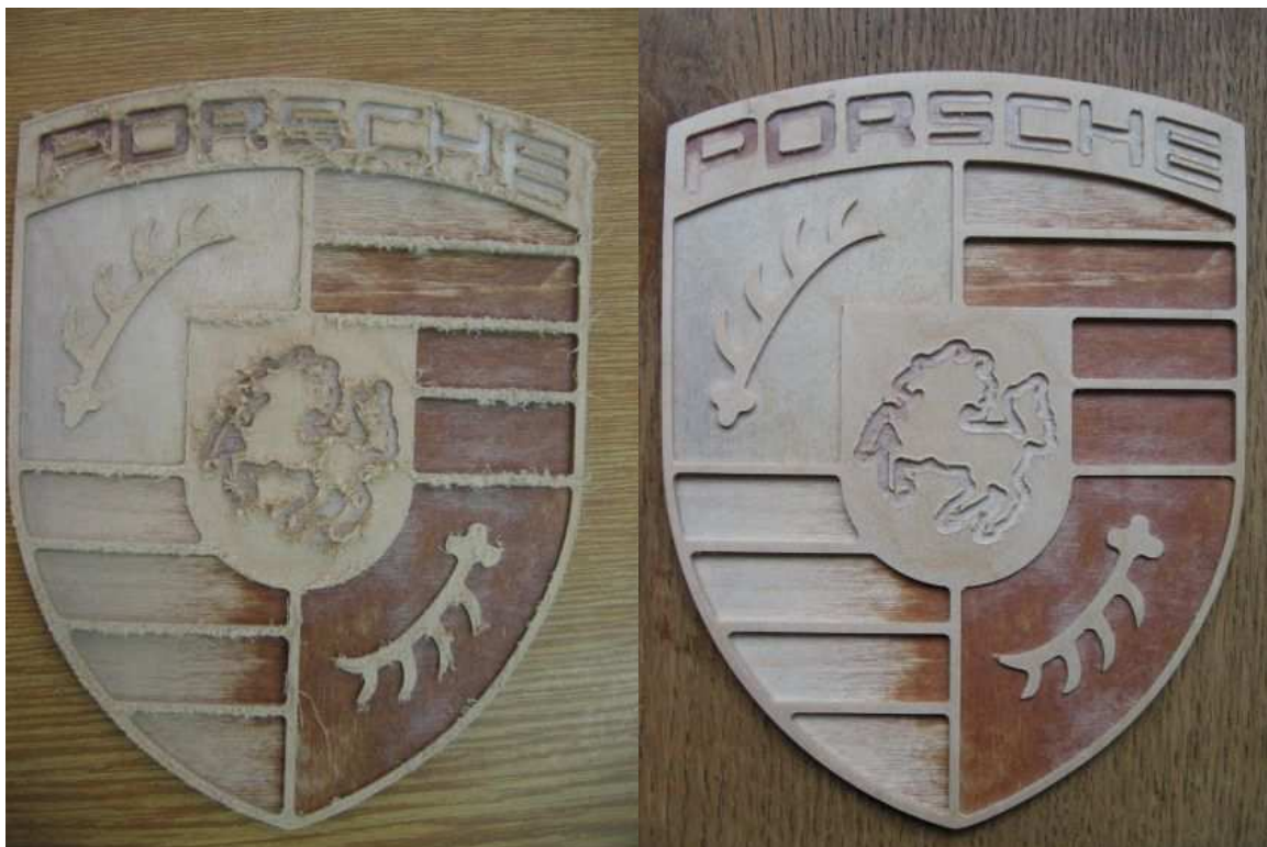
Obr. 27. Druhá verze znaku vlevo ihned po frézování, vpravo po začištění smirkovým papírem
