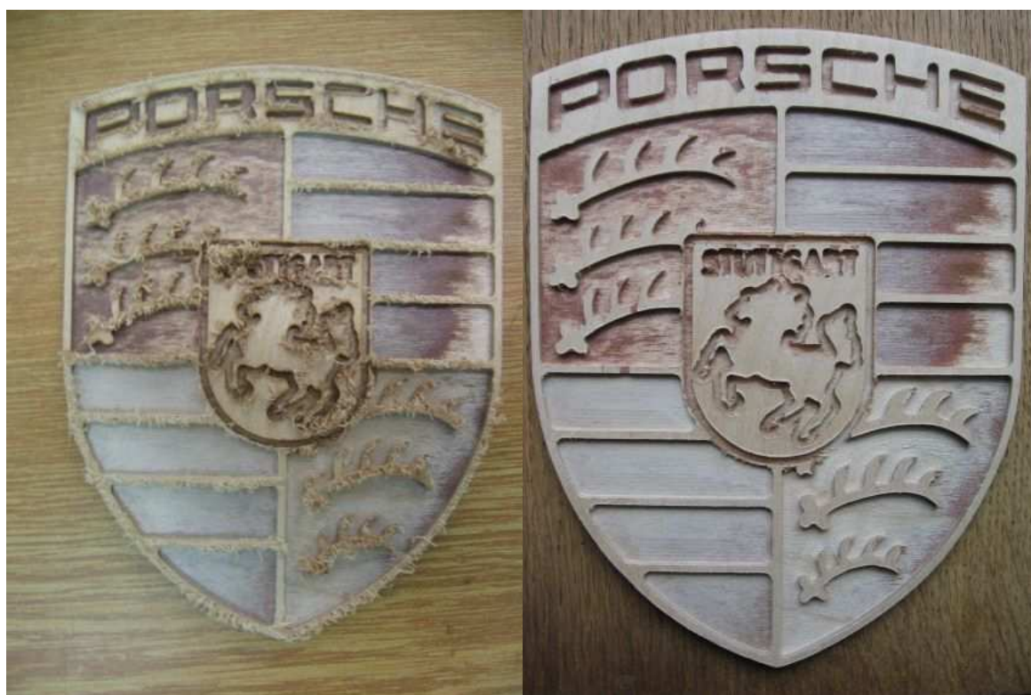
Obr. 26. První verze znaku vlevo ihned po frézování, vpravo po začištění smirkovým papírem
