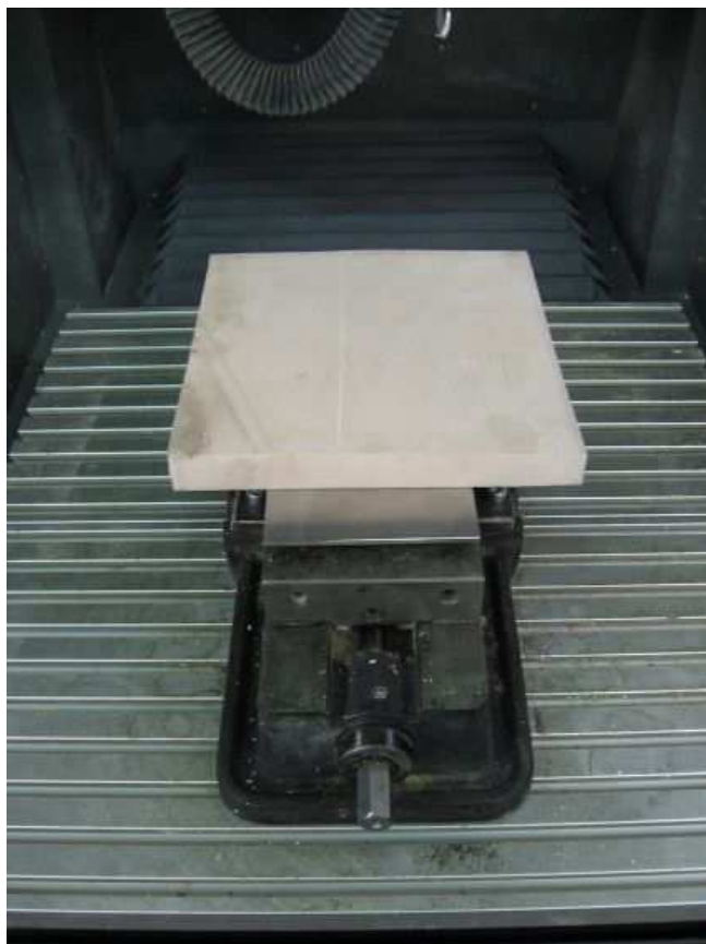
Obr. 30. Polotovár připravený k obrábění
