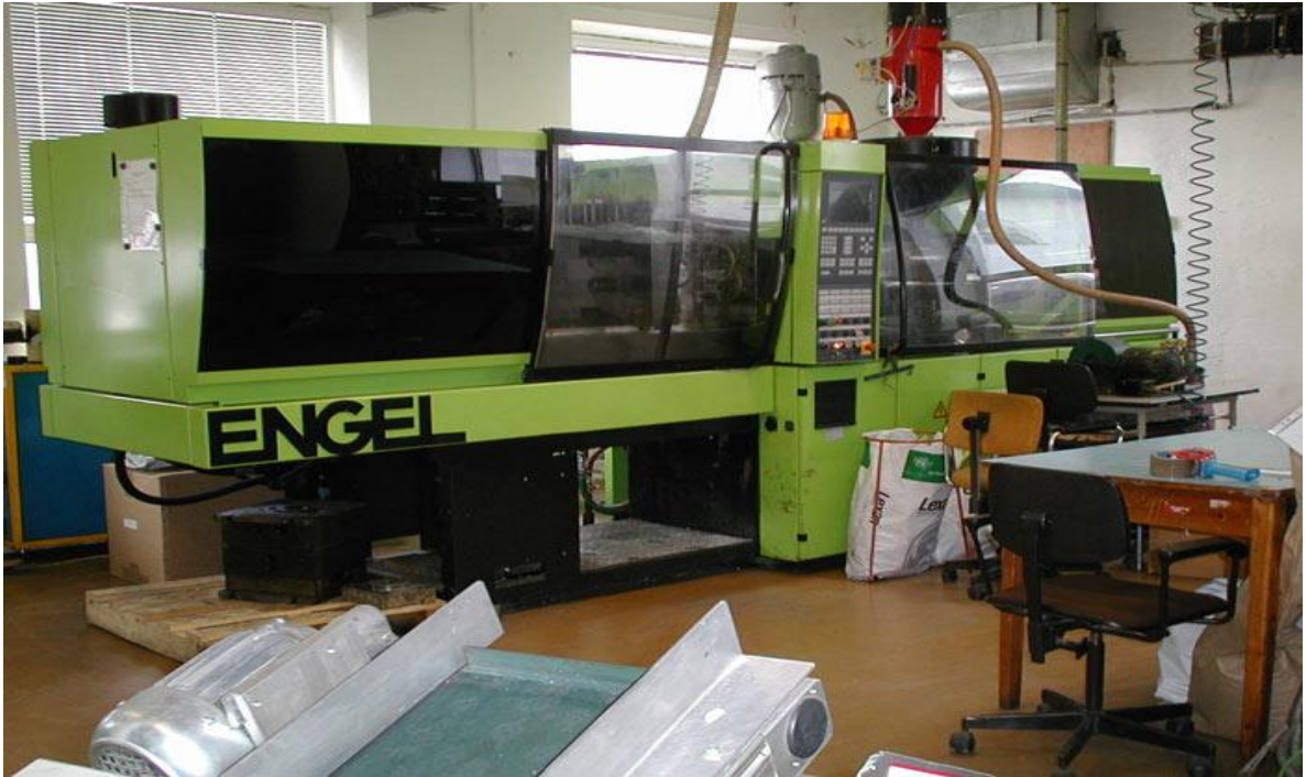
Obr. 12. Použitý vstřikovací stroj ENGEL 330/80/HL
